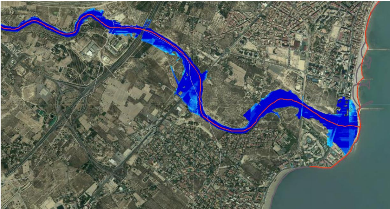
Peligrosidad por inundación fluvial a periodo de retorno T500 años, lámina de calados (expresada en metros) para la ARPSI “VINALOPÓ-RÍO SECO” [ES080_ARPS_0003]. Fuente: Sistema Nacional de Cartografía de Zonas Inundables – Inventario de Presas y Embalses (SNCZI-IPE). Elaboración propia.
